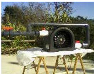
El [kit hidráulico para la turbina PLT](#) se entrega en PVC y PN 16bar (foto izq.)
