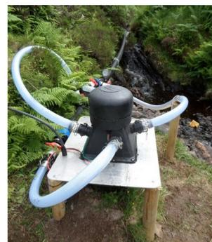
Para la turbina LH o LH-M se puede suministrar una ampliación excéntrica en PVC, para acoplar a la base de la turbina.
